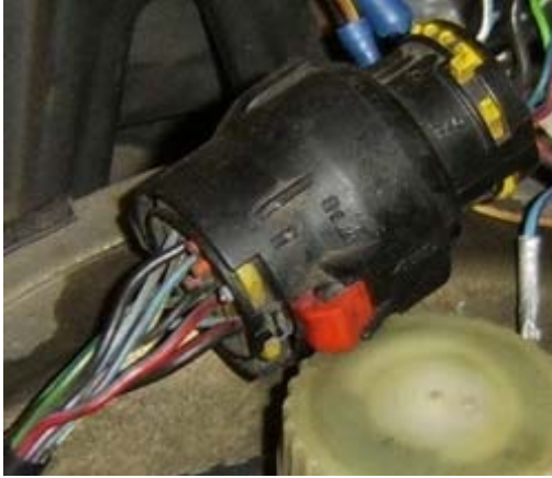
Stecker X5 – Kadett E C16NZ und C20XE (Motorraum)
