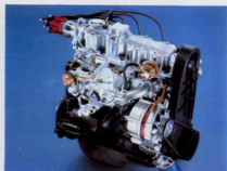
Der neue 1.6 S-OHC-Motor.
