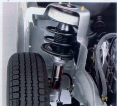
Federbeinachse vorn nach dem McPherson-Prinzip.
