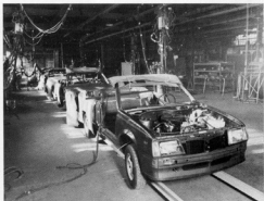
Die Fahrzeuge werden während der gesamten Verstärkungsmaßnahmen auf Schienen hydraulisch entlang bewegt.
