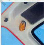
Rechts oben: Das Funkgerät und die Bedienelemente der Warmanlage können nachträglich in die Mittelkonsole integriert werden. Eine entsprechende Vorrichtung ist als Sonderausstattung bereits ab Werk erhältlich. Rechts mitte: Doppel-Innenpiegel. Rechts unten: Zusätzliche Blinkleuchte an der Heckklappe innen.
