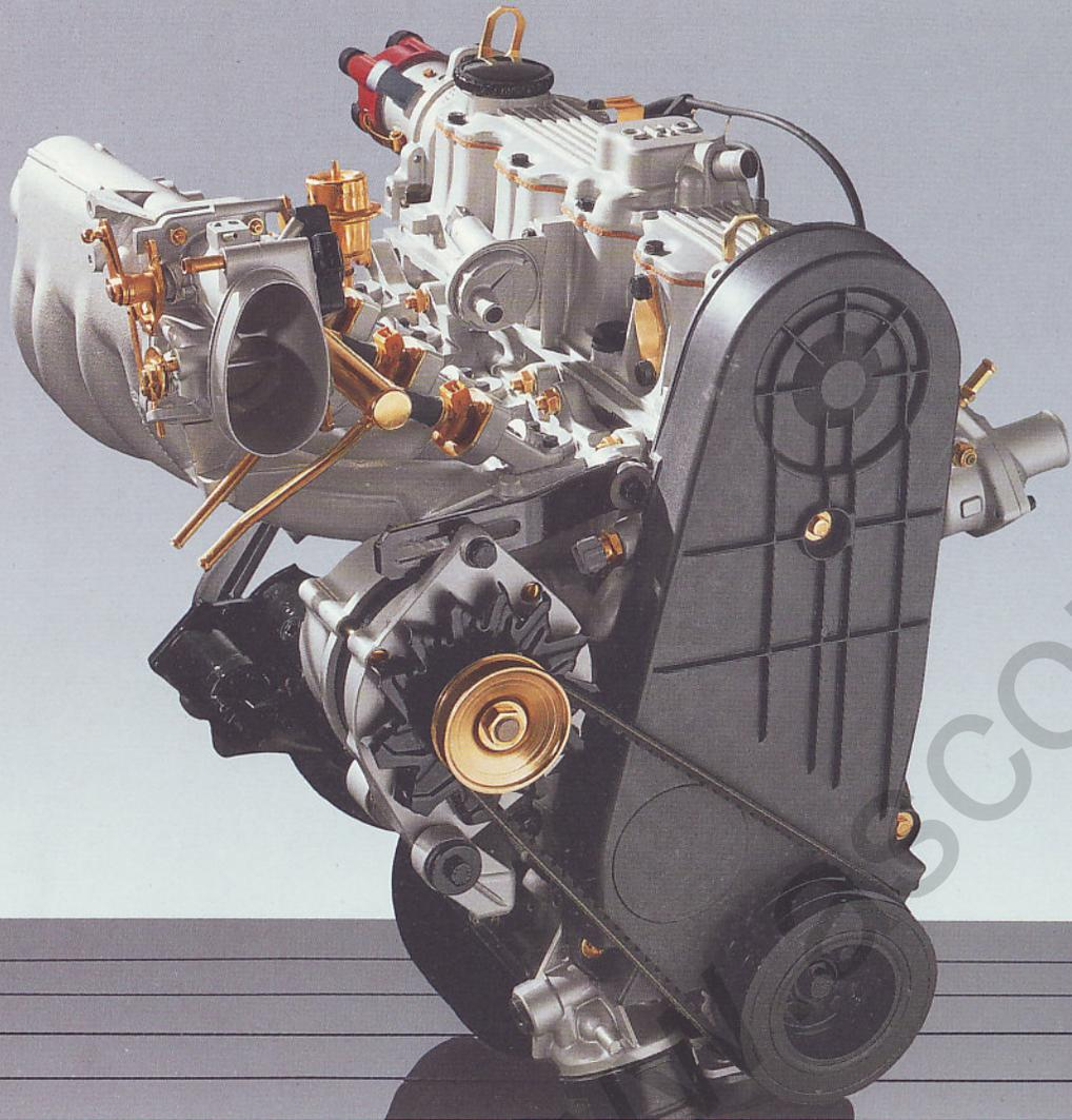
Zur Grundausstattung dieses Fahrzeugs gehören neben dem 1.8i-OHC-Motor und dem Keramik-Monolith-Katalysator das 5-Gang-Schongetriebe, Stabilisatoren vorn und hinten sowie die
