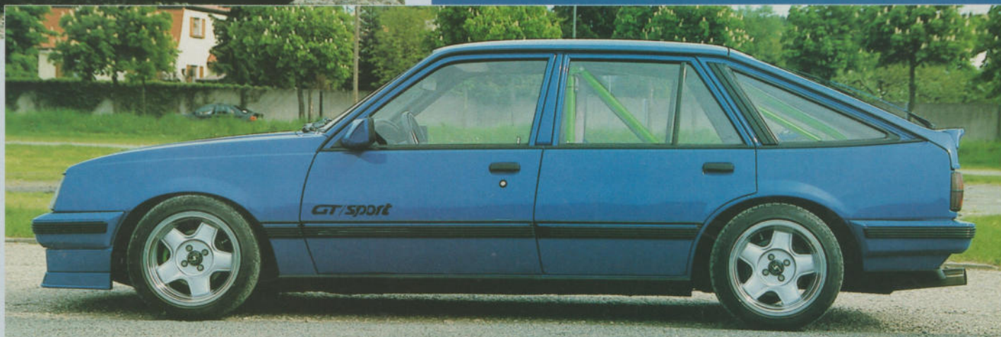
KAW-Fahrwerk in 75/50er Version in Verbindung mit Schmidt Revo Modern Line 8 x 15 ET10 mit 195/50 Toyo PXT1
