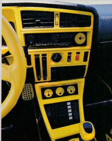
Ascona-Mittelkonsole mit Zusatzinstrumenten (Öldruck, Öltemp, Wassertemp)
